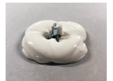
ボードアンカーと接着剤を複合させて固定します
