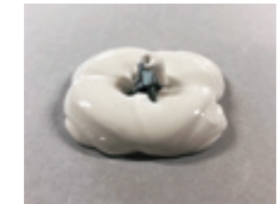
ボードアンカーと接着剤を複合させて固定します
